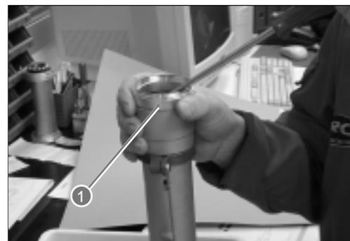
Con un cacciavite largo esercitare una pressione sotto l'anello di tenuta e contemporaneamente ruotare lo scorrevole, per permettere la fuoriuscita, sfilare lo scodellino inferiore sottostante
