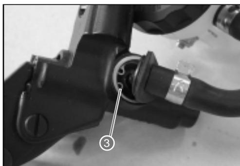
**Sostituire l'O-ring con uno nuovo.**
