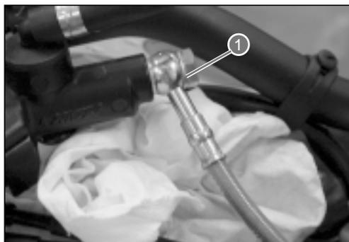
**Rimuovere immediatamente il liquido dei freni che entrasse in contatto con qualsiasi parte della motocicletta. Il liquido reagisce chimicamente con vernice, plastica, gomma, ecc., causando severi danni.**
