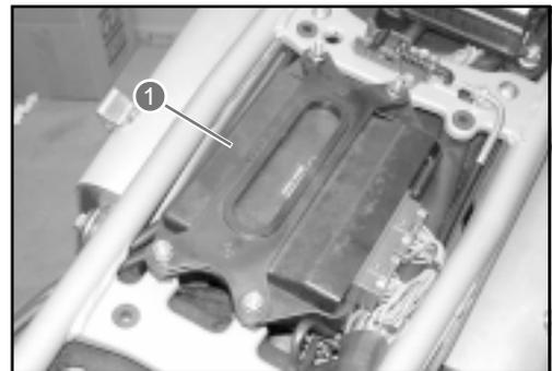
Controllare il voltaggio di picco del sensore della posizione dell'albero motore tra i fili Verde/Blu e Viola/Blu sull'accoppiatore dell'ECM.
